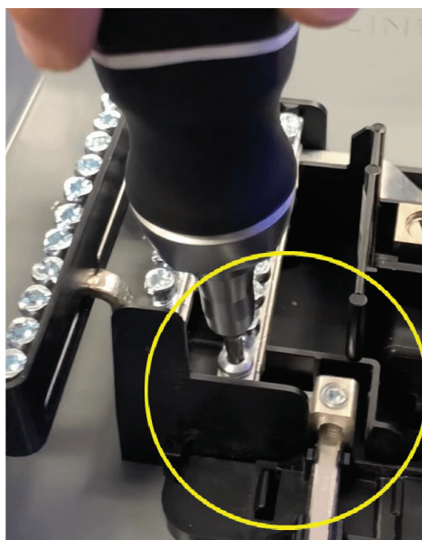
Figure 7 – Vérifier si le connecteur PoN gauche bouge
