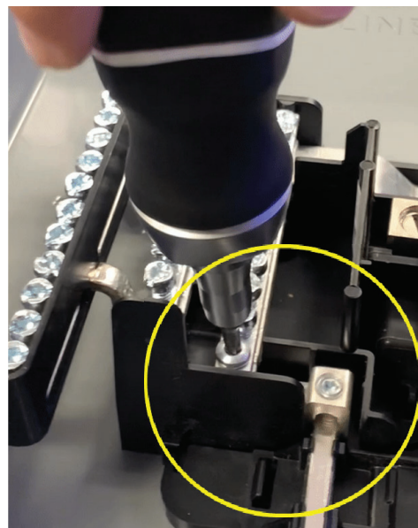
Figura 7 – Inspeccione el movimiento del conector PoN izquierdo
