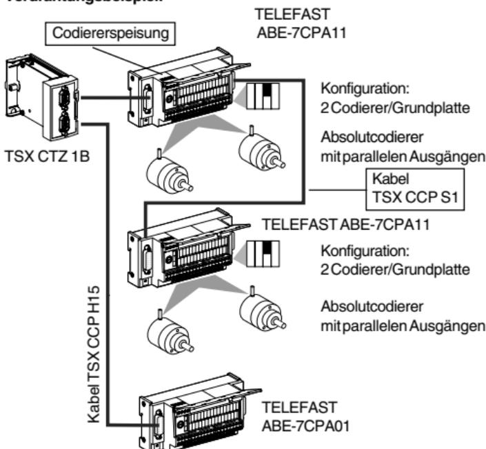
**Anschluss des 15-poligen Sub-D-Steckverbinder am Modul ABE-7CPA01**
