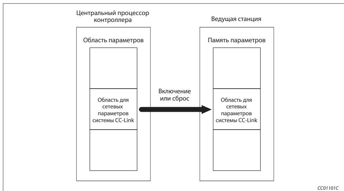
Рис. 6-1: Передача сетевых параметров в ведущую станцию
