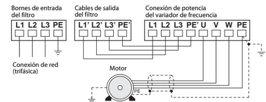
Los cables entre el convertidor de frecuencia y el motor deben apantallarse con el fin de reducir las radiaciones parásitas. El apantallamiento del cable del motor se debe ejecutar extensamente por el lado del convertidor de frecuencia.
