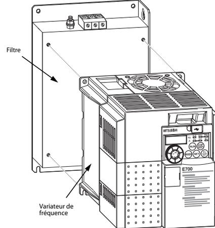
Vissez ensuite l'unité composée d'un filtre et du variateur de fréquence sur l'embase de montage de l'armoire électrique à l'aide de vis adaptées (non fournies). Afin d'obtenir une action du filtre optimale, il est nécessaire que le boîtier du filtre antiparasites et l'embase de montage mise à la terre soient ensembles conducteurs. Cela est normalement réalisé en vissant les filtres sur la plaque de montage.
