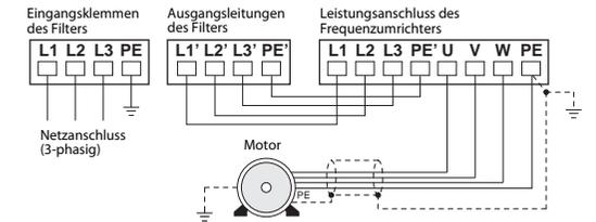
Die Leitung zwischen Frequenzumrichter und Motor ist zwecks Reduzierung der Funkstrahlung geschirmt auszuführen. Der Schirm der Motorleitung ist motor- und frequenzumrichterseitig großflächig aufzulegen.
