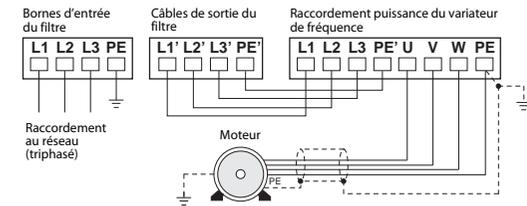
Le câble entre le variateur de fréquence et le moteur est blindé afin de réduire les émissions parasites. Le blindage du câble moteur doit être largement dimensionné côté moteur et côté variateur de fréquence.
