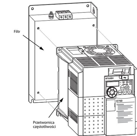
W celu zamontowania zespołu filtr - falownik na płycie montażowej rozdzielnic użyj odpowiednich śrub, (śruby te nie są dostarczane wraz z filtrem). Aby zapewnić poprawne działanie filtra, należy połączyć go elektrycznie z płytą montażową rozdzielnic, która musi mieć prawidłowe połączenie do uziemienia. W razie potrzeby usunąć farbę w miejscu styku filtra z płytą montażową rozdzielnic.
