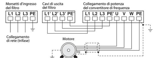
Per ridurre l'emissione di radiodisturbi, il cavo fra l'inverter e il motore deve essere schermato. Lo schermo del cavo motore deve essere collegato su entrambe le estremità con un'ampia superficie di contatto.
