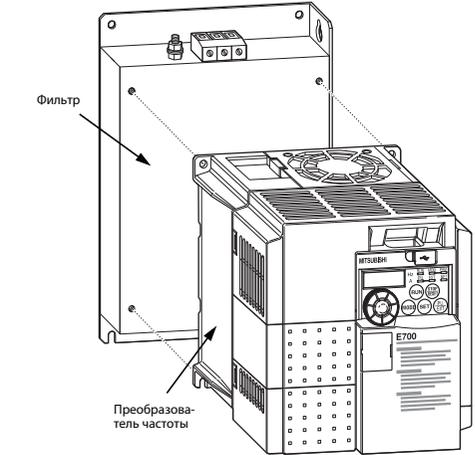
После этого блок, состоящий из фильтра и преобразователя частоты, следует закрепить подходящими винтами (не входящими в комплект фильтра) на монтажной панели распределительного шкафа. Для достижения оптимального фильтрующего действия необходимо, чтобы корпус фильтра имел электропроводящее соединение с заземленной монтажной панелью. Как правило, это соединение образуется через винты крепления фильтра на монтажной панели. Если необходимо, удалить эмаль в соответствующих местах монтажной панели.
