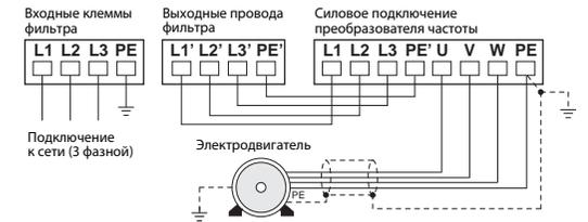
Для уменьшения излучения помех провод между преобразователем частоты и двигателем должен быть экранированным. Экран провода двигателя следует заземлить как со стороны двигателя, так и со стороны преобразователя частоты, при этом поверхность контакта должна быть как можно больше.
