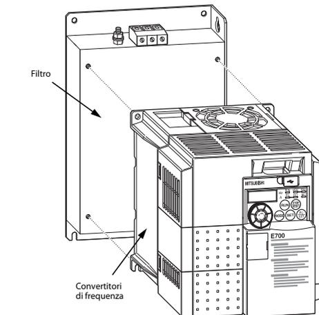
L'unità filtro-inverter va quindi fissata con le apposite viti (non comprese nella fornitura del filtro) alla piastra di montaggio dell'armadio elettrico. Per ottenere un effetto ottimale del filtro è necessario eseguire il collegamento conduttivo dell'alloggiamento del filtro EMC e della piastra di montaggio collegata a terra. Questo si ottiene di norma fissando il filtro con viti alla piastra di montaggio. Nei punti di contatto rimuovere eventualmente la vernice dalla piastra di montaggio.
