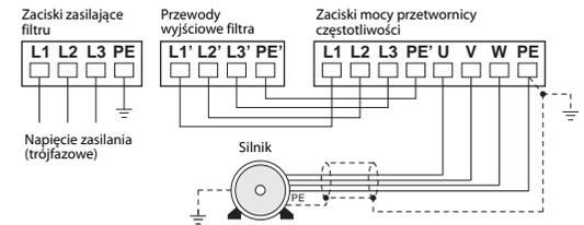
W celu zredukowania emisji zakłóceń, kabel ekranowany silnika musi być uziemiony na obu końcach.
